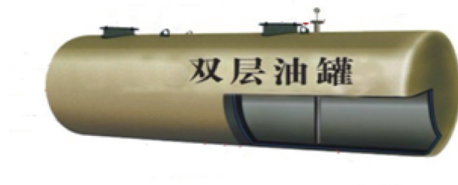
图 6.2.4 双层油罐基本结构
