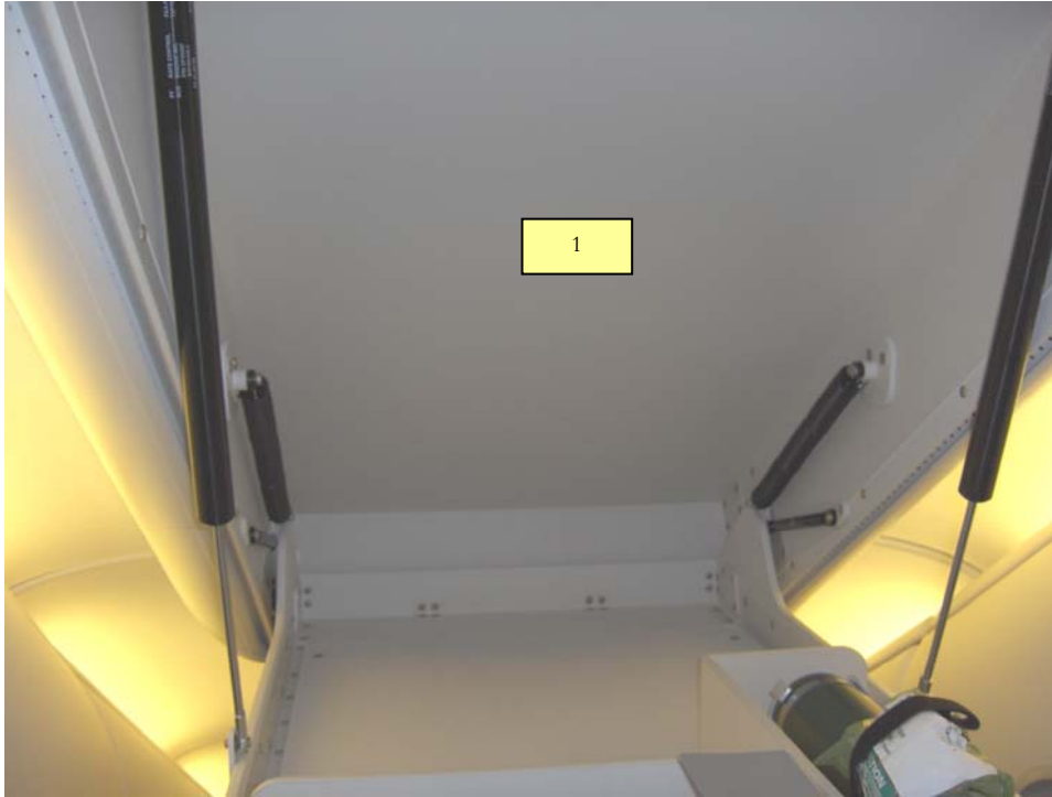
图 22：中央顶部救生船存放处—内部
