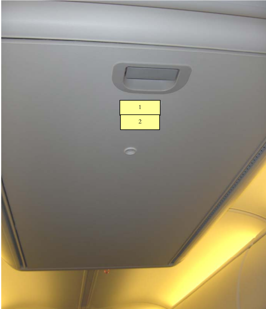
图 21：中央顶部救生船存放处—外部
