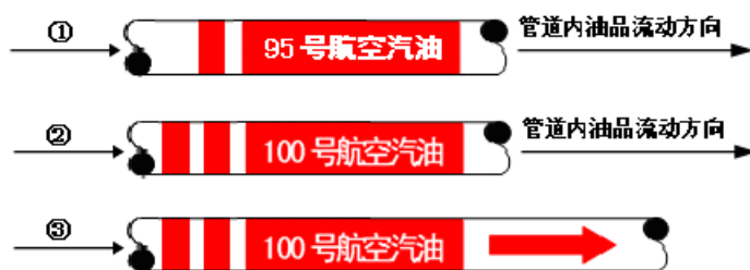
图 2 航空汽油输油管道标识
