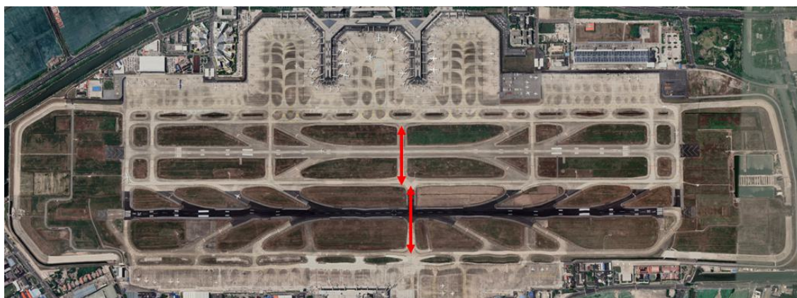
图 7.1-1 A 机场穿越道位于跑道中部的“高能量区”
